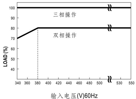
备注：当双相输入电压在340~380 Vac之间，环境温度在-10℃~-30℃之间，冷启动时，电源可能会出现打嗝，此时通常电源将在5~10秒后正常启动。
